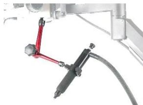
Bras rotatif (360°) de maintien de torche pour fines applications d'assemblage.
