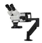
Stéréo microscope binoculaire sur bras articulé / Zoom x4 x20 avec éclairage froid par anneau lumineux LED.
